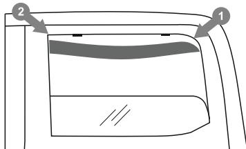
Der Deflektor muss von hinten beginnend eingebaut werden. Legen Sie dazu den hinteren Teil des Deflektormrahmens in den Kanal und schieben Sie den vorderen Teil nach oben. Positionieren Sie den gesamten Deflektormrahmen in den Scheibenkanal und platzieren Sie den Rahmen zwischen den Befestigungsbügeln und der Gummidichtung, wie in der Abbildung gezeigt.
