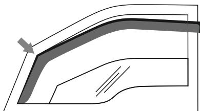
Spostare il deflettore in avanti, inserendo completamente il telaio del deflettore all'interno della canalina. Assicurarsi che il deflettore sia posizionato sopra il telaio inferiore del finestrino.
