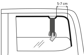
Per posizionare l'accessorio, piegare il bordo della guarnizione in gomma dal telaio posteriore del finestrino di 5-7 cm, utilizzando una speciale piastra metallica, come mostrato nell'immagine.
