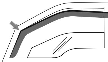
6. Déplacez le déflecteur vers l'avant, en ajustant complètement le cadre du déflecteur dans le canal. Assurez-vous que le déflecteur est placé au-dessus du cadre inférieur de la fenêtre.
