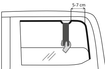
Um die Befestigung zu positionieren, biegen Sie die Kante der Gummidichtung vom hinteren Rahmen der Scheibe mit Hilfe einer speziellen Metallplatte um 5-7 Zentimeter ab, wie in der Abbildung gezeigt.
