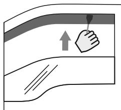
Um eine bessere Montage des Deflektors und eine bessere Haftung zwischen dem Band und der Oberfläche der Gummidichtung zu gewährleisten, wird dringend empfohlen, die Kunststoffklinge zu verwenden und sie langsam zwischen der inneren Gummidichtung der Scheibe und dem Deflektor zu bewegen.
