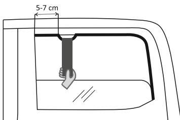
Piegare il bordo della guarnizione in gomma dal telaio anteriore del finestrino di 5-7 cm. Posizionare la staffa di fissaggio nella canalina e riportare la guarnizione in gomma alla sua posizione originale.
