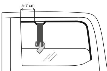
Biegen Sie den Rand der Gummidichtung vom Vorderrahmen der Scheibe um 5-7 Zentimeter. Platzieren Sie den Befestigungsbügel in den Kanal und bringen Sie die Gummidichtung wieder in ihre ursprüngliche Position zurück.
