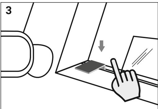
Platzieren Sie den Metallbügel auf der unteren Gummidichtung so nah wie möglich am Rahmen der Frontscheibe.
