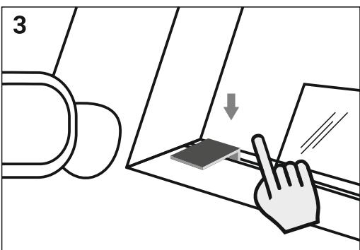
Posizionare la staffa metallica sulla guarnizione in gomma inferiore, il più vicino possibile al telaio del finestrino anteriore.
