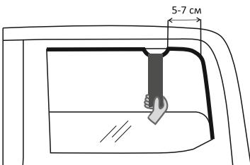
Для установки крепления, с помощью специальной металлической пластины отогните край уплотнительной резинки на 2-3" от задней рамки окна, как показано на рисунке.
