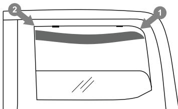
Начинать установку дефлектора необходимо с задней части, для этого уприте заднюю часть рамки дефлектора в канал и поднимайте переднюю часть рамки дефлектора вверх. Полностью вставьте всю рамку дефлектора в канал окна, таким образом, чтобы рамка дефлектора оказалась между креплениями и уплотнительной резинкой. Как показано на рисунке.
