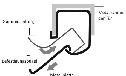
Das Bild zeigt, wie der Befestigungsbügel zu positionieren ist.
