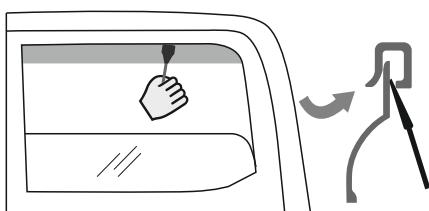
9. Pour assurer une meilleure installation du déflecteur et une meilleure adhérence entre le ruban et la surface du joint en caoutchouc, il est vivement recommandé d'utiliser la lame en plastique en déplaçant lentement entre le joint en caoutchouc intérieur de la fenêtre et le déflecteur ;
