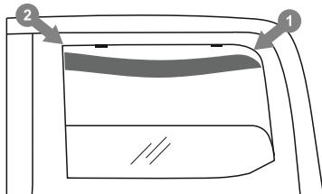
7. Le déflecteur doit être installé en commençant par l'arrière.
