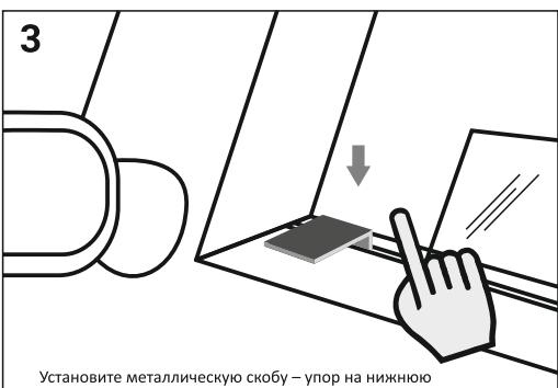
Установите металлическую скобу - упор на нижнюю уплотнительную резинку как можно ближе к передней рамке окна.
