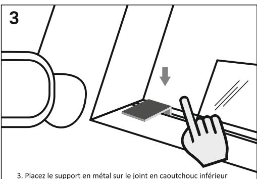
3. Placez le support en métal sur le joint en caoutchouc inférieur aussi près que possible du cadre de la fenêtre avant.
