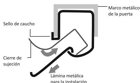
3. Coloque el soporte de sujeción en el riel y vuelva a colocar el filo de goma en su posición original.
