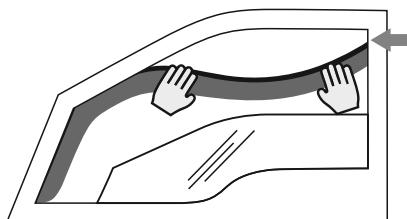
Biegen Sie den mittleren Teil des Deflektors nach außen, führen Sie den hinteren Teil des Deflektors in den Kanal ein und halten Sie darüber einen Spalt frei.
