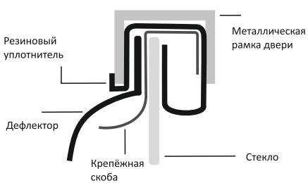
Установите крепёжную скобу в канал и верните уплотнительную резинку в обычное состояние.
