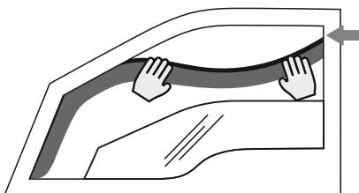
Отклонив центральную часть дефлектора наружу, вставьте заднюю часть дефлектора в канал, но оставьте зазор сверху.
