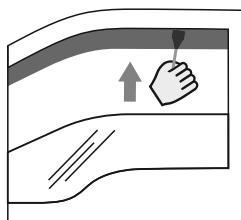
10. Pour assurer une meilleure installation du déflecteur et une meilleure adhérence entre le ruban et la surface du joint en caoutchouc, il est vivement recommandé d'utiliser la lame en plastique en la déplaçant lentement entre le joint en caoutchouc intérieur de la fenêtre et le déflecteur.
