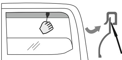
Um eine bessere Montage des Deflektors und eine bessere Haftung zwischen dem Band und der Oberfläche der Gummidichtung zu gewährleisten, wird dringend empfohlen, die Kunststoffklinge zu verwenden und sie langsam zwischen der inneren Gummidichtung der Scheibe und dem Deflektor zu bewegen.
