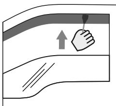
Для более качественной установки дефлектора и увеличения адгезии скотча и поверхности уплотнительной резинки используйте пластиковую лопатку, проводя ей между внутренней уплотнительной резинкой окна и дефлектором.
