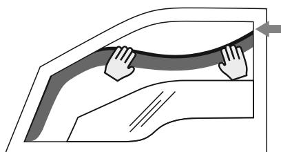
7. En pliant la partie centrale du déflecteur vers l'extérieur, insérez la partie arrière du déflecteur dans le canal en laissant un espace au-dessus de celui-ci.
