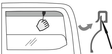
Per una migliore installazione del deflettore e un'adesione ottimale tra il nastro e la superficie della guarnizione in gomma, si consiglia di utilizzare la spatola di plastica, muovendola lentamente tra la guarnizione in gomma interna del finestrino e il deflettore.
