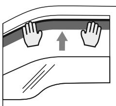
8. En commençant par la partie avant du déflecteur, insérez-le dans le canal de la fenêtre.
