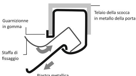
Posizionare la staffa di fissaggio nella canalina e riportare la guarnizione in gomma alla sua posizione originale.
