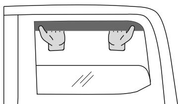
8. Inmediatamente después de instalar el deflecto, ajuste la posición tirando hacia fuera con cuidado.
